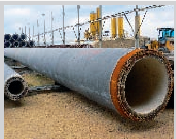
Cerucuk terbesar telah dibangunkan dengan diameter sebesar 1400mm oleh ICP Jiangmen, China
