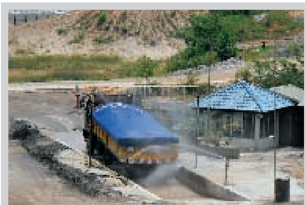
Sistem perenjis digunakan untuk melembapkan muatan di atas lori di kuari-kuari kami
